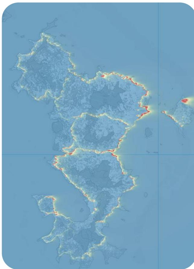
Figure 12 : Prototype de carte de simulations réalisable pour la dispersion du NO<sub>2</sub> pendant 3 heures à l'échelle de Mayotte via le modèle SIRANE. (Stage de Félix LEFÈVRE - 2023)
