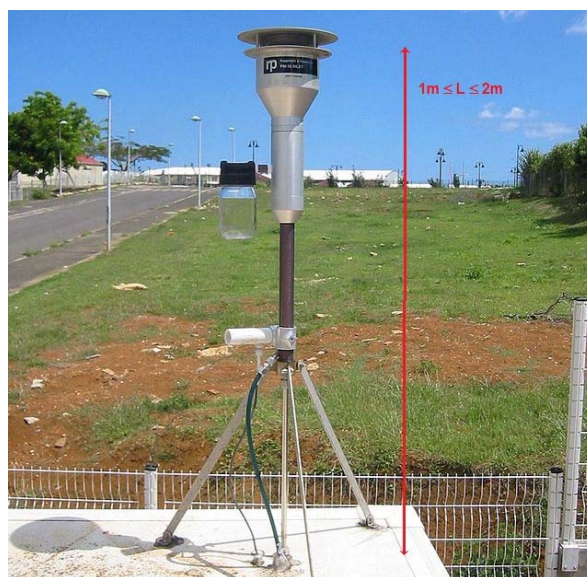
Figure 5: Exemples de configuration de point de prélèvement en toiture de bâtiment (canne de prélèvement gaz – à gauche -, tête PM – à droite)
