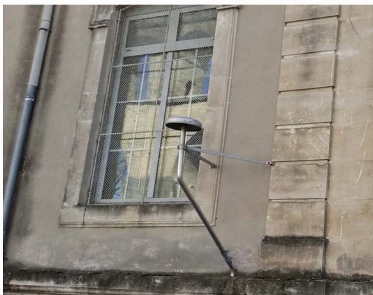
Figure 6 : Exemple de configuration de point de prélèvement en façade de bâtiment
