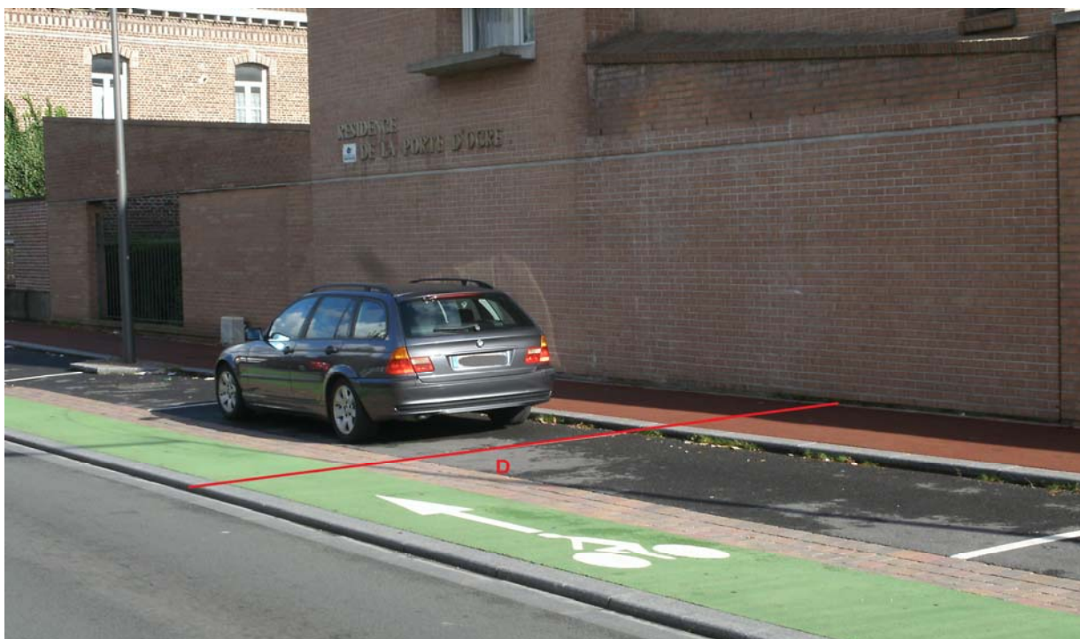
Figure 4 : Distance entre point de prélèvement et bordure de voirie ( D \leq 10\text{m} )
